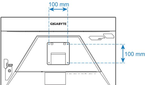
**Nota:** Para montar el monitor en la pared, consulte la guía de instalación que se incluye en el kit de soporte de montaje en pared. Tamaño del tornillo de montaje VESA: M4 x 20 mm mínimo.
