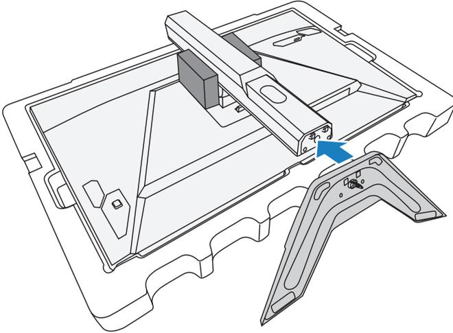
3. Levante el tornillo de anillo y gírelo en el sentido de las agujas del reloj para asegurar la base del monitor en su sitio.
