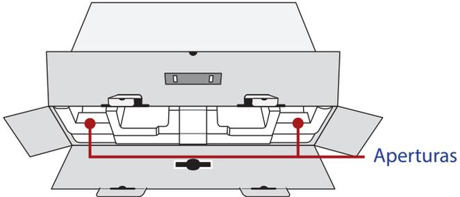
4. Sujete el ensamblaje de espuma EPS (a través de las aberturas) para extraerlo de la caja.
