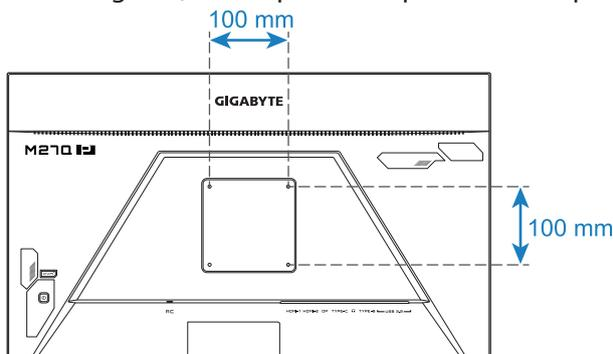
**Nota:** Para montar o monitor na parede, consulte o guia de instalação que está incluído no kit de suporte de montagem na parede. Tamanho do parafuso de montagem VESA: M4 x 20mm mínimo.
