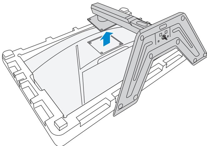
4. 取り付けブラケットをディスプレイ背面の取り付け穴に取り付けます。次に、ネジを使用して、ブラケットを所定の位置に固定します。
