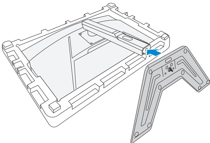
4. ネジのリングを持ち上げ、時計回りに回して、所定の位置にディスプレイベースを固定します。
