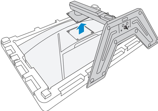
4. Bringen Sie die Montagehalterung an den Montagelöchern an der Rückseite des Monitors an. Sichern Sie die Halterung dann mit den Schrauben.
