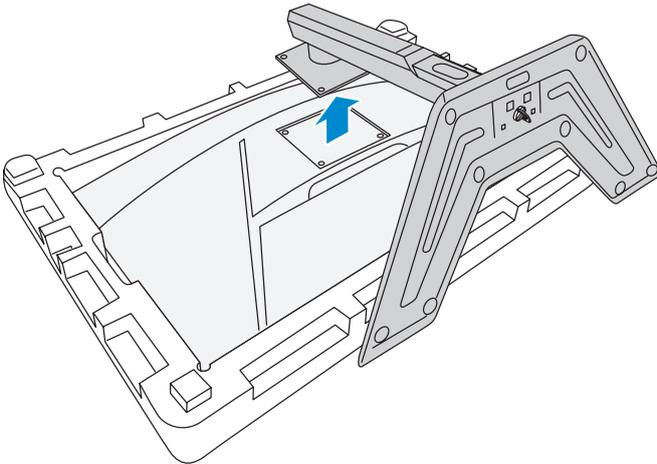
4. 將安裝托架安裝至顯示器後方的安裝孔。然後使用螺絲將托架固定至定位。
