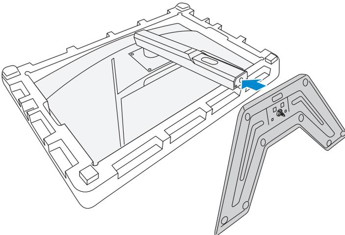
4. 提起螺絲環並順時針旋轉，將顯示器底座固定至定位。
