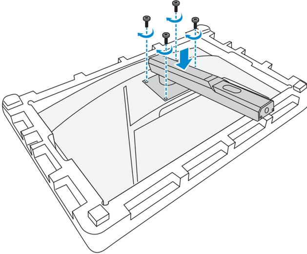
3. 將顯示器底座對準支架下方的固定座。然後將底座安裝至支架。
