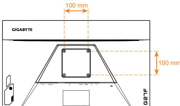
**참고 :** 모니터를 벽면에 장착하려면 벽 장착 브라켓 키트에 포함된 설치 가이드를 참조하십시오.
