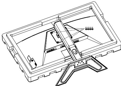
3. 取り付けブラケットをディスプレイ背面の取り付け穴に取り付けます。次に、ネジを使用して、ブラケットを所定の位置に固定します。
