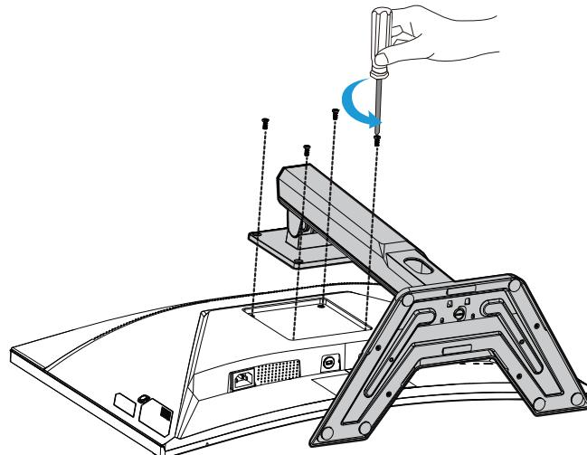
3. 稍微向下拉动支架,以分离挂钩。然后拆下支架。
