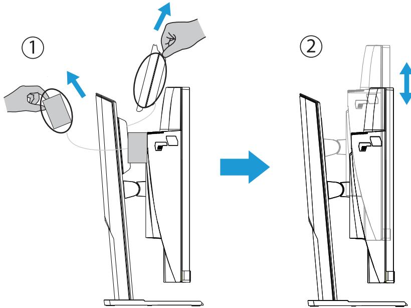
3. 将显示器放在包装垫或平面上，屏幕朝下。撕开 EPE 袋，将支架安装在显示器背面。然后，您可以抓住支架臂从下部 EPS 泡沫中取出显示器。小心抬起显示器。把它垂直放在桌子上。
