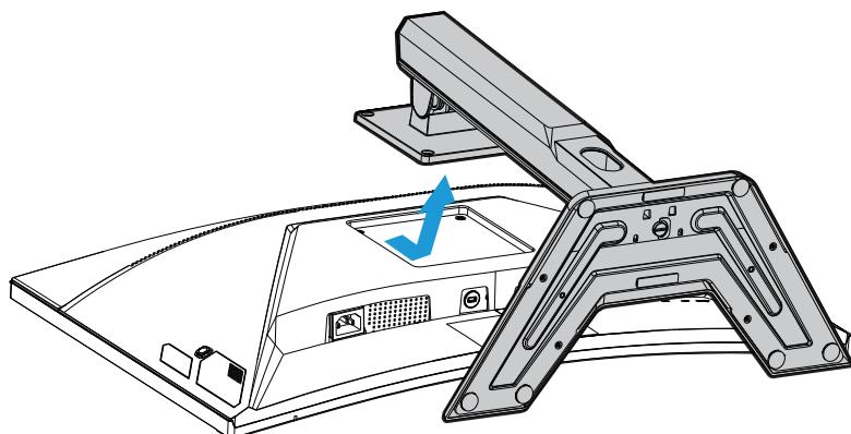
4. 将安装支架装配到显示器后部的安装孔上。然后使用螺钉将支架固定到位。
