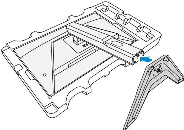
4. Heben Sie den Schraubring an und drehen Sie ihn im Uhrzeigersinn, um den Monitorfuß in seiner Position zu sichern.
