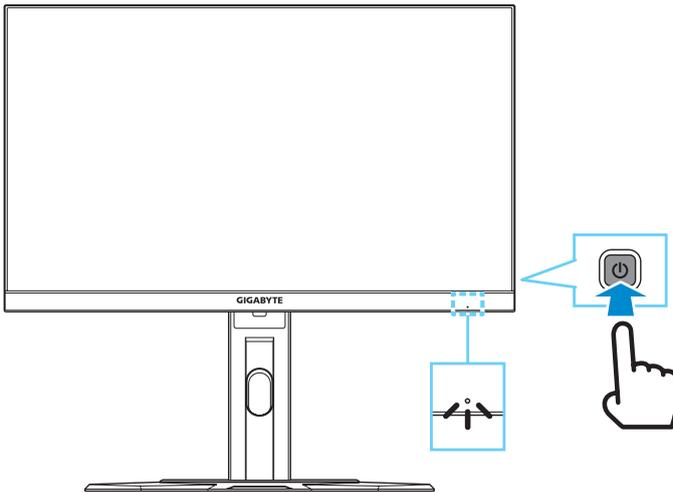
**注意事項：**如果無訊號，顯示器將顯示**無訊號**通知一段時間。隨後，顯示器將進入省電模式，電源 LED 亮白燈並開始每隔一秒閃爍一次。
