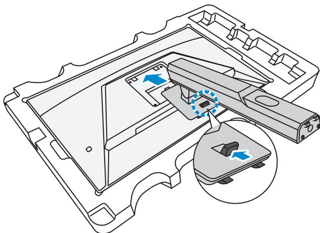
3. 將顯示器底座對準支架下方的固定座。然後將底座安裝至支架。
