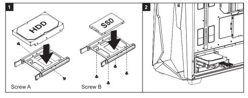
5.2 For 2.5" cage / 2.5" 插槽 / 2.5" 插槽
