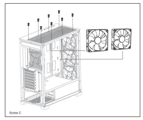
7. Cooling System Support / 散熱系統支援 / 散热系统支持
