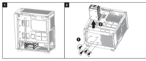
\*The 3.5" cage can be disassembled when the users need more space for installing the PSU. \*依需求拆卸3.5" 硬碟架可獲得更多的電源供應器安裝空間 \*依需求拆卸3.5" 硬碟架可获得更多的电源供应器安装空间
