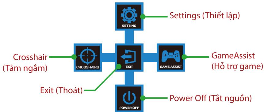
Sau đó sử dụng nút **Control (Điều khiển)** để chọn chức năng mong muốn và cấu hình các thiết lập liên quan.
