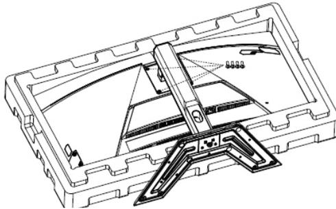
3. Fije el soporte de montaje a los orificios de montaje en la parte posterior del monitor. Luego use los tornillos para asegurar el soporte en su lugar.
