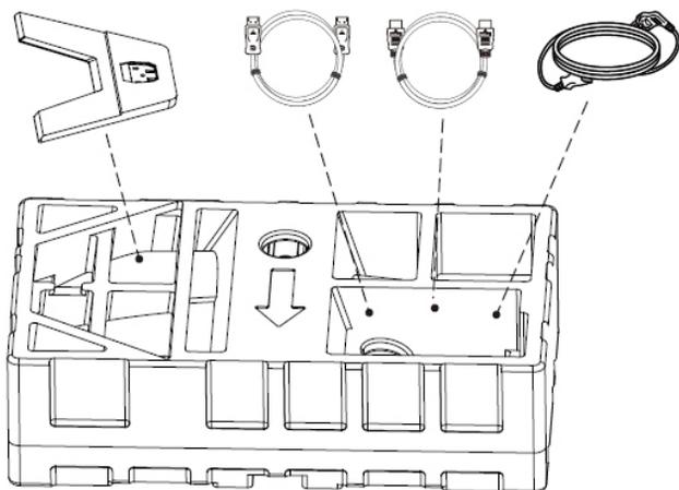
6. Retire la espuma superior de EPS. A continuación, puede quitar el monitor de la espuma de EPS inferior.
