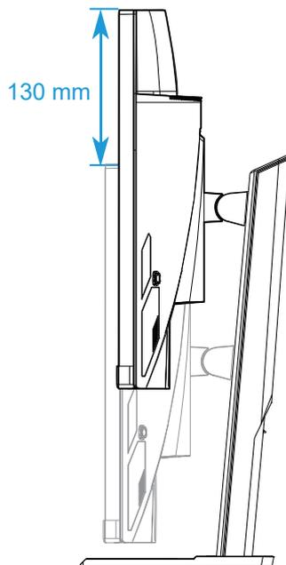
**Nota:** Antes de realizar el ajuste de altura, asegúrese de haber retirado la placa de seguridad del soporte.
