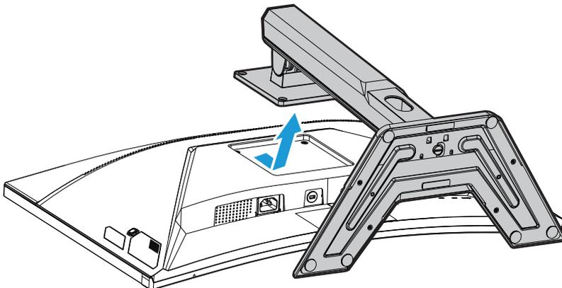
4. Acople el brazo de montaje en los agujeros de montaje en la parte trasera del monitor. A continuación, use los tornillos para asegurar el brazo en su sitio.
