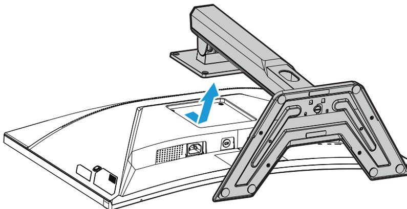
4. Bringen Sie die Montagehalterung an den Montagelöchern an der Rückseite des Monitors an. Sichern Sie die Halterung anschließend mit Schrauben.
