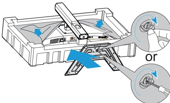
**Hinweis:** Sie können die Schraube mit einer Münze oder einem kleinen Schlitzschraubendreher festziehen.
