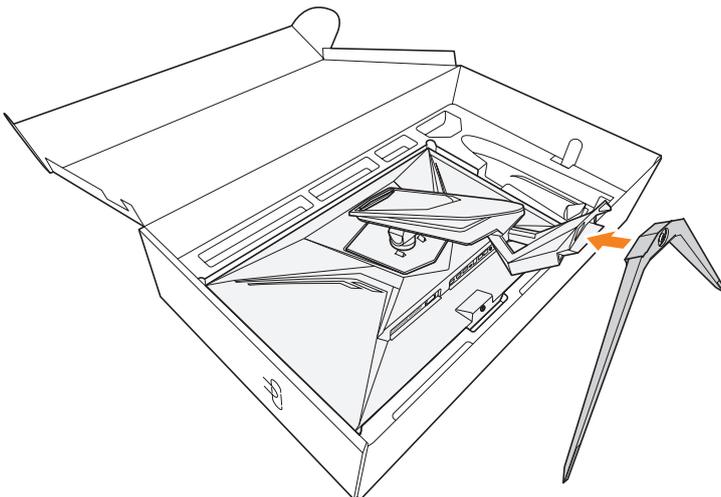
4. ネジのリングを持ち上げ、時計回りに回して、所定の位置にディスプレイベースを固定します。
