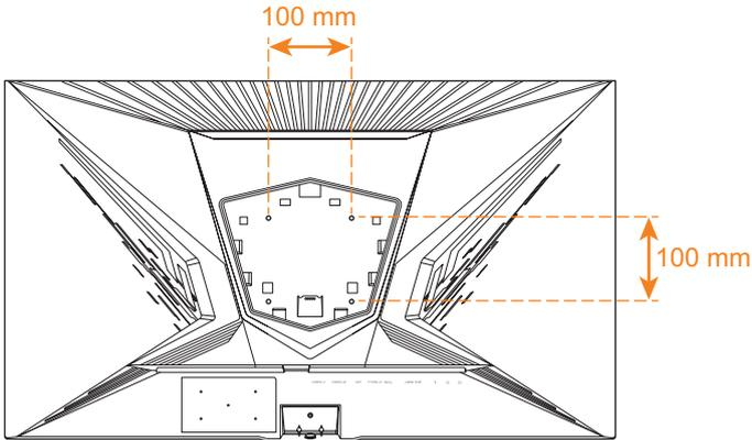
**注:**ディスプレイを壁に取り付ける場合は、壁取り付けブラケットキットに含まれる取り付けガイドを参照してください。VESA 取り付けネジのサイズ: M4 x 15 mm (最小)。
