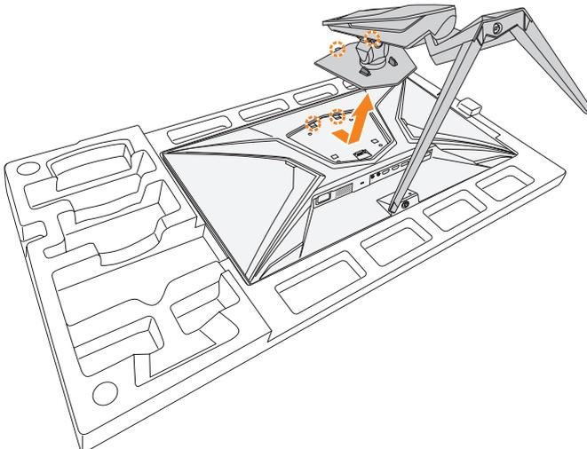
4. Fixez le support de montage avec les trous de fixation situés à l'arrière du moniteur. Utilisez ensuite les vis fournies pour fixer le support en place.
