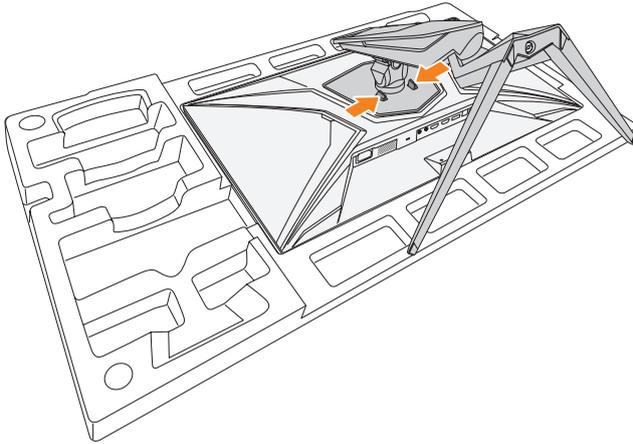
3. Tirez légèrement le support vers le bas pour dégager les crochets de verrouillage. Retirez ensuite le support.
