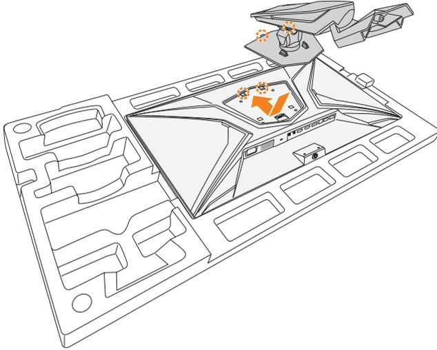
3. 将显示器底座与支撑臂下方的螺丝柱对齐。然后将底座连接到支撑臂上。
