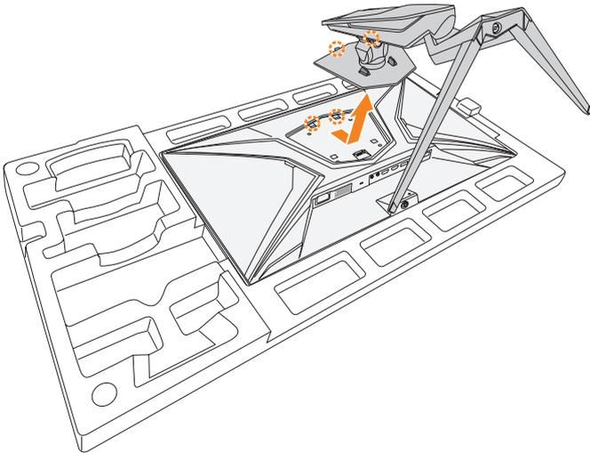
4. 将装配架连接到显示器背面的壁挂架螺丝孔中。然后用螺丝将装配架固定到位。
