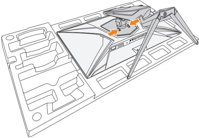
3. 轻轻拉下支撑臂，以松开挂钩。然后取下支撑臂。
