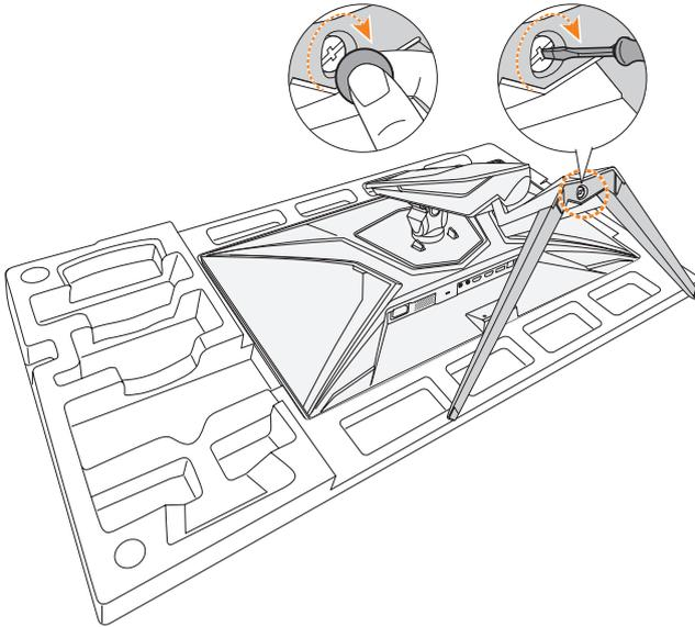
**Hinweis:** Sie können die Schraube mit einer Münze oder einem kleinen Schlitzschraubendreher festziehen.
