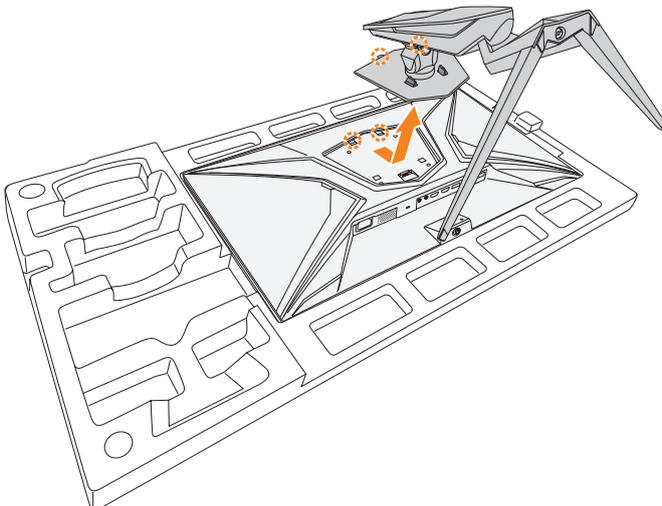
4. Bringen Sie die Montagehalterung an den Montagelöchern an der Rückseite des Monitors an. Sichern Sie die Halterung dann mit den Schrauben.
