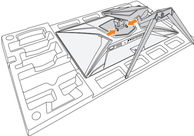
3. Ziehen Sie den Ständer zum Lösen der Haken leicht nach unten. Entfernen Sie dann den Ständer.
