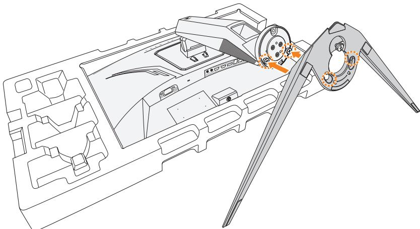
4. 逆時針旋轉顯示器底座以鎖入定位。然後鎖緊螺絲以固定底座。
