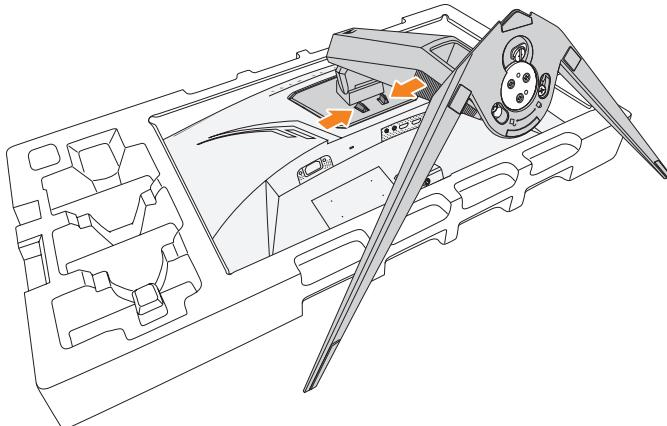
3. 將支架向下輕拉以鬆脫固定鉤，然後取下支架。
