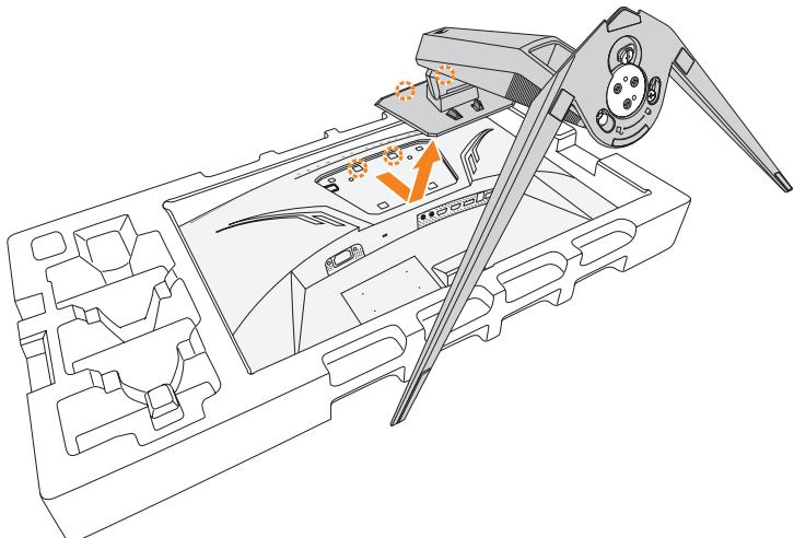
4. 將安裝托架安裝至顯示器後方的安裝孔。然後使用螺絲將托架固定至定位。
