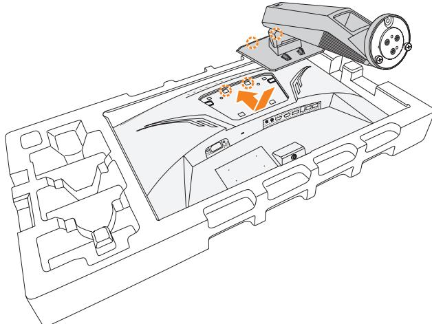
3. 將顯示器底座對準支架下方的兩個導銷。然後將底座安裝至支架。
