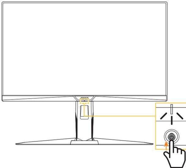
**注:** ディスプレイをオンに切り替えた後、電源 LED がオフのままであるときは、設定メニューで、**LED インディケーター**の設定を確認してください。38 ページを参照してください。
