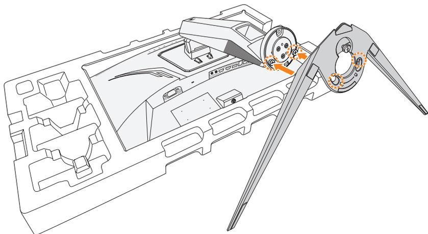
4. ディスプレイベースを反時計回りに回して、所定の位置にロックします。次に、ネジを締めて、ベースを固定します。
