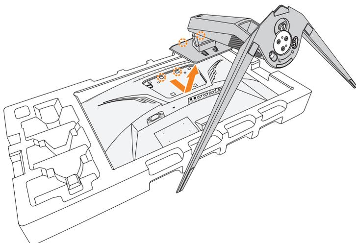
4. 取り付けブラケットをディスプレイ背面の取り付け穴に取り付けます。次に、ネジを使用して、ブラケットを所定の位置に固定します。
